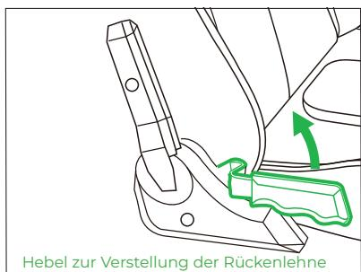
Hebel zur Verstellung der Rückenlehne
